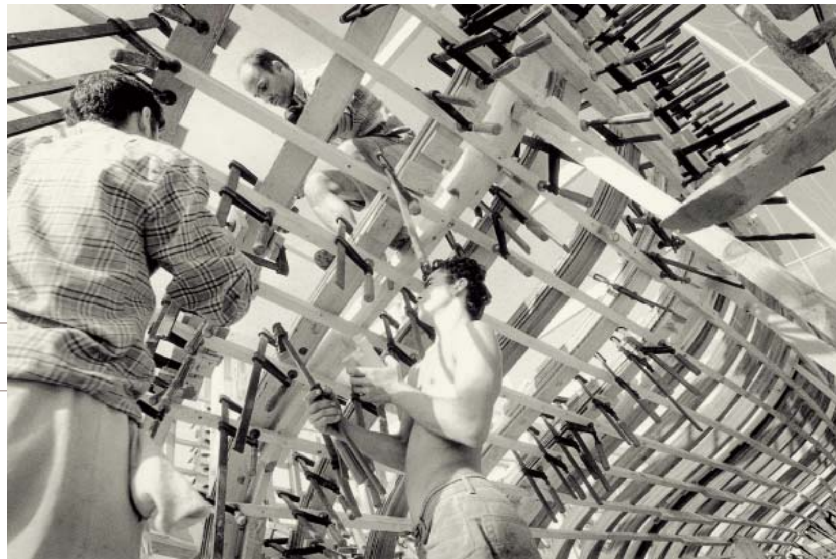
Gespickt mit Schraubzwingen, die eine starke Hand erfordern, nimmt die Gulet Form an – vorübergehend die eines Stachelschweins
